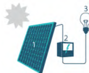
1. Zonnepaneel | 2. Omvormer | 3. Elektrische toestellen
